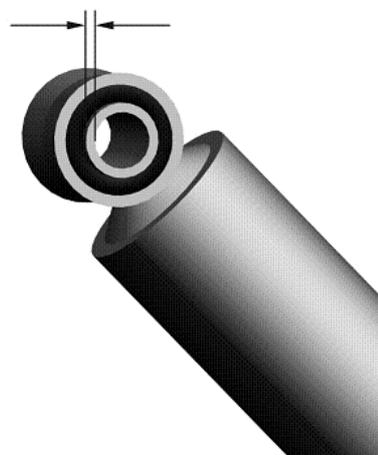
Para la fijación del amortiguador al soporte ECO Air Compact será necesario un mayor par de apriete en comparación con los de las hasta ahora conocidas ejecuciones Airlight II. Esto requiere un reforzamiento en el casquillo.
