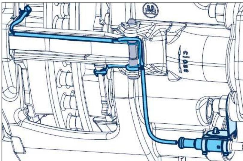
El nuevo kit del sensor de desgaste con referencia 05.801.49.50.0 es compatible para todos los frenos TSB y puede ser reequipado en todo momento. La nueva referencia 05.801.49.50.0 sustituye a la referencia antigua 05.801.50.49.0.
