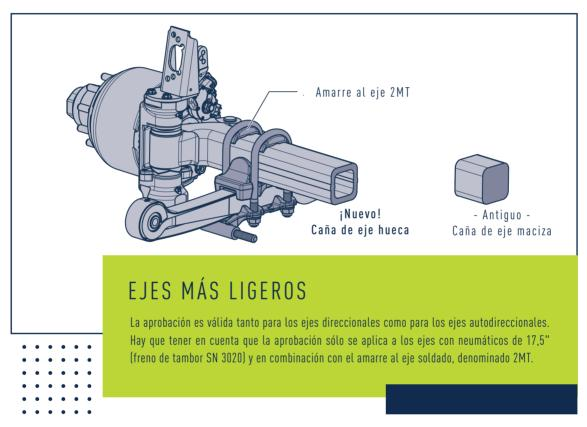
Gracias a la optimización de componentes individuales, como un amarre al eje perfectamente adaptado, la caña de eje hueca está ahora aprobada para cargas de eje de hasta 12 t. Para esta aprobación hemos llevado a cabo pruebas exhaustivas, incluso en los bancos de prueba Hydro-Puls de nuestro propio centro de pruebas.
