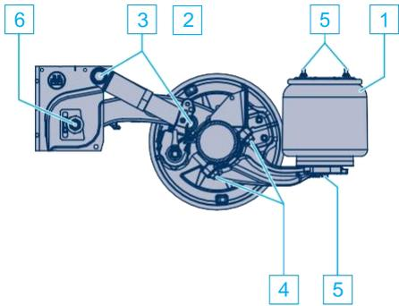
Módulo com foles de suspensão pneumática separado (foles combinados)
